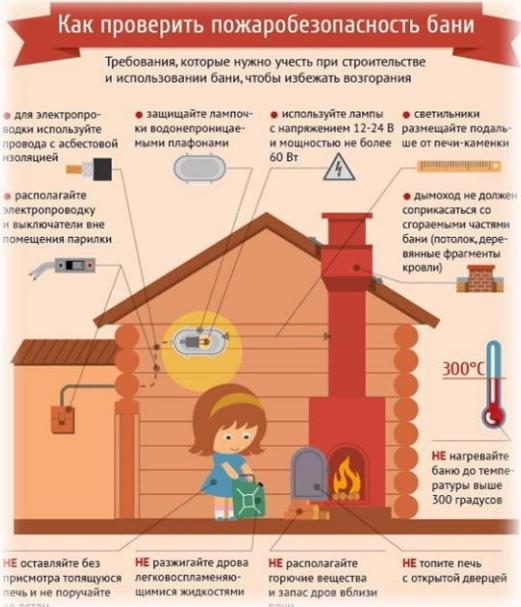
Все деревянные части здания должны находиться на достаточном расстоянии от печи и дымоходов или должны быть хорошо изолированными от них, для чего применяется кирпич, асбест, листы минирита и другие негорючие материалы. Конструкции потолка из горючих материалов, не защищенные от возгорания, должны находиться от верха перекрытия кирпичной печи на расстоянии не меньше 35 см, а у металлических печей – на расстоянии не менее 1,2 метра.
